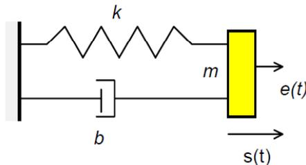
La masse  $m$  est reliée au bâti par un ressort de raideur  $k$  et un amortisseur visqueux (frottements) de coefficient  $b$
