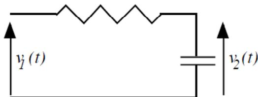
$$v_1 = R.i + v_2$$
