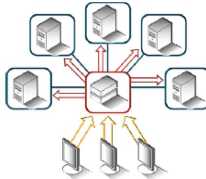
Equilibrage de charge sur un réseau (*électrique, telecom*)
