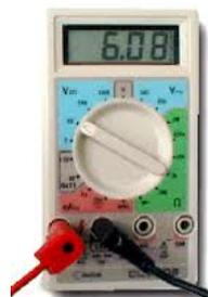
Multimètre à affichage digital (volt, A, Ohmmètre)
