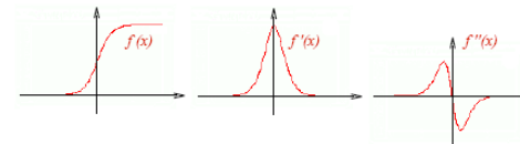
les contours (image de droite) constituent une simplification de l'image utile dans de nombreuses applications. Dans les approches linéaires, ils sont en général obtenus à partir des maxima locaux de la dérivée première, ou des passages par zéro de la dérivée seconde.
