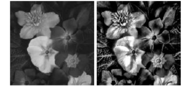
rehaussement de contraste obtenu par combinaison linéaire avec le laplacien.
